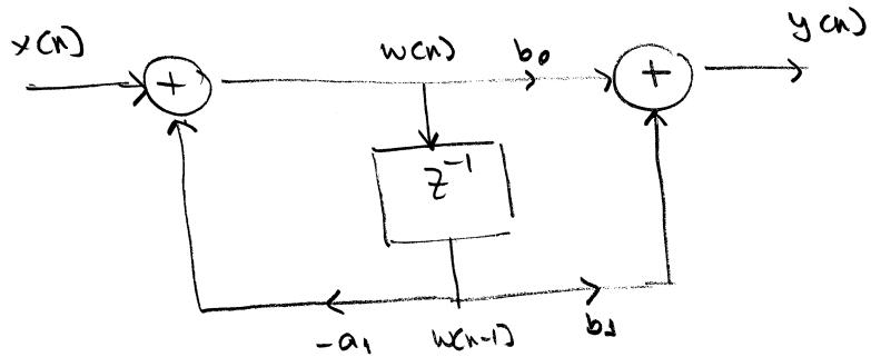
Esta estructura requiere solo 1 delay y de forma se puede generalizar de modo que
